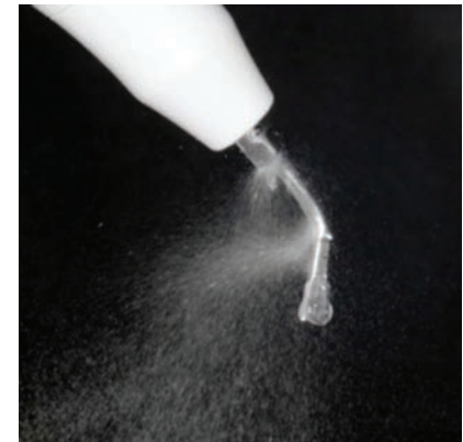
Resim 3. Vibrasyonun olduğu uç kısmında, devamlı mikropatlamlar ve bir şok dalgası oluşur. Bu şok dalgası kavitasyon olarak adlandırılır. Kemik cerrahisinde kavitasyon etkisi önemlidir. Kavitasyon esnasında enerji açığa çıkarak lokal ısı artışı ve basınç değişimine sebep olur. Walmsly ve ark. (1988) kavitasyonun bakteri hücre duvarını parçaladığını ve antibakteriyel etkinliğe sahip olduğunu bildirmiştir. Ayrıca kavitasyon etkisi ile hemostaz sağlanarak kansız bir operasyon sahası elde edilir.
